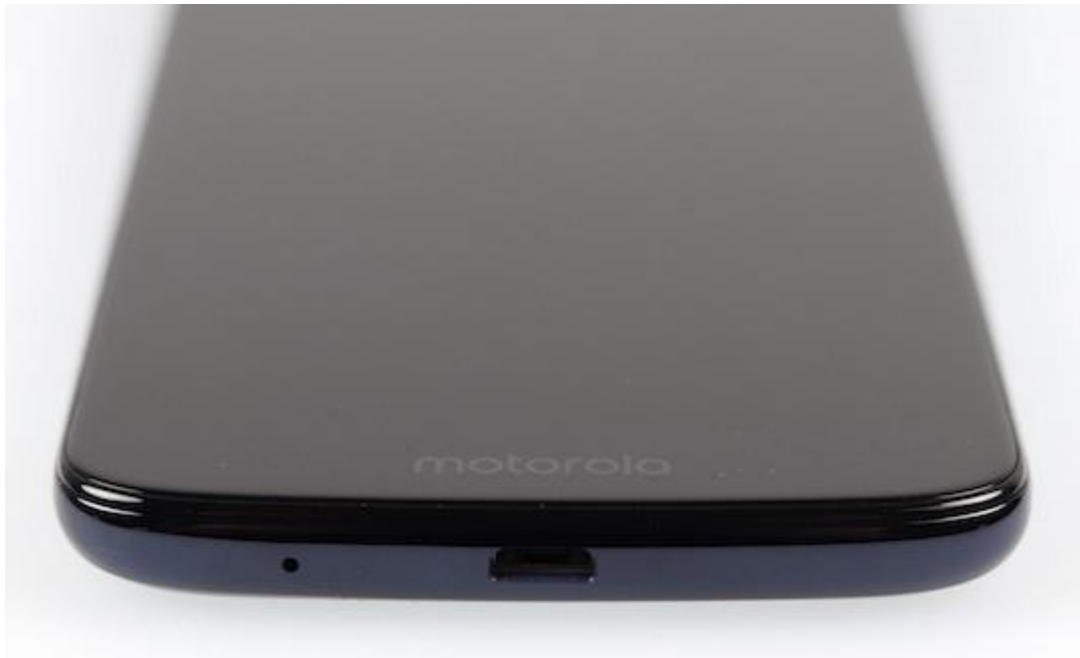
Auf der Unterseite befindet sich der Micro-USB-Anschluss.
