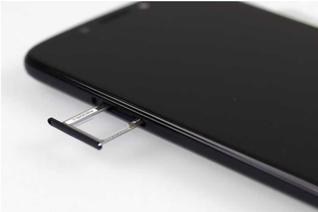
Der Dual-Sim- und SD-Karten-Slot ist auf der linken Seite des Gehäuses verbaut.
